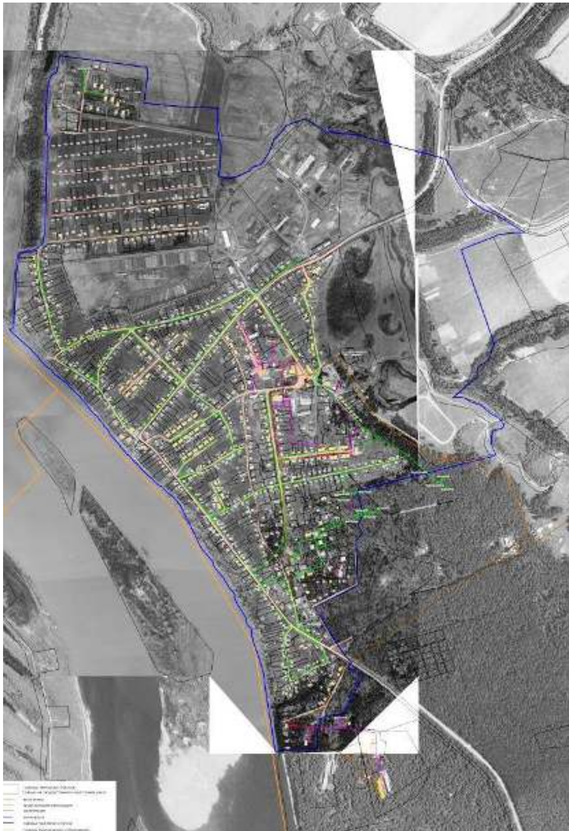
Рис. 1 Существующая зона действия котельных с. Елькаево
