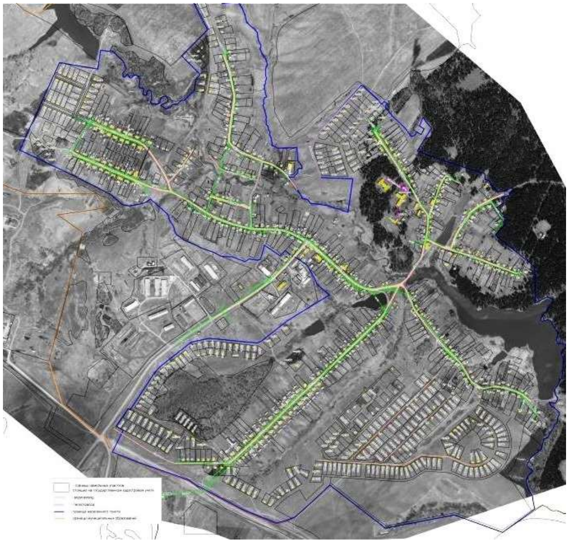
Рис. 3 Существующая зона действия котельной с. Андреевка
